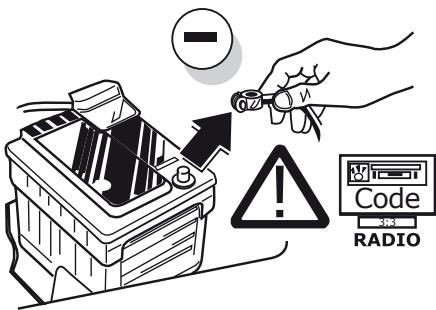
**(DE)** Um Störungen und Schäden am Bordnetz zu vermeiden, muss die Massepolklemme unbedingt vor Beginn aller Arbeiten von der Fahrzeubatterie getrennt werden! Insbesondere bei Arbeiten und Anschlüssen am CAN-Datenbus kann bei nicht abgeklemmter Batterie sowohl das Anhängermodul als auch das fahrzeugeigene Bordnetzsteuergerät beschädigt werden! Bitte Herstellervorschriften beim Ab- und Anklemmen der Fahrzeubatterie beachten!
